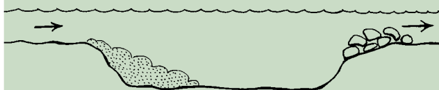
Sandfang fra siden.
